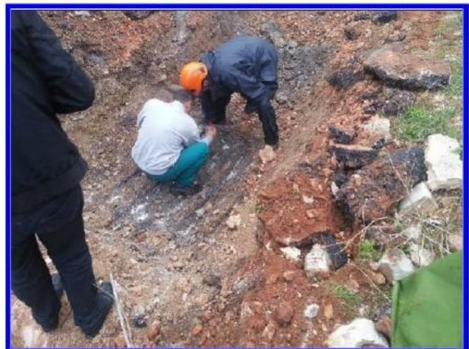
*Formazione del campione di conglomerato bituminoso Scavo 3*
