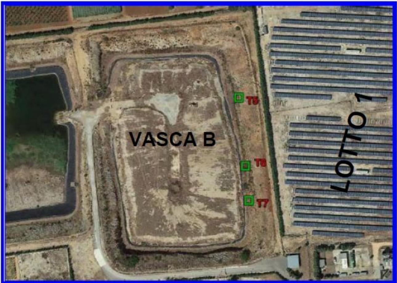
*Planimetria con punti di esecuzione trincee esplorative*
